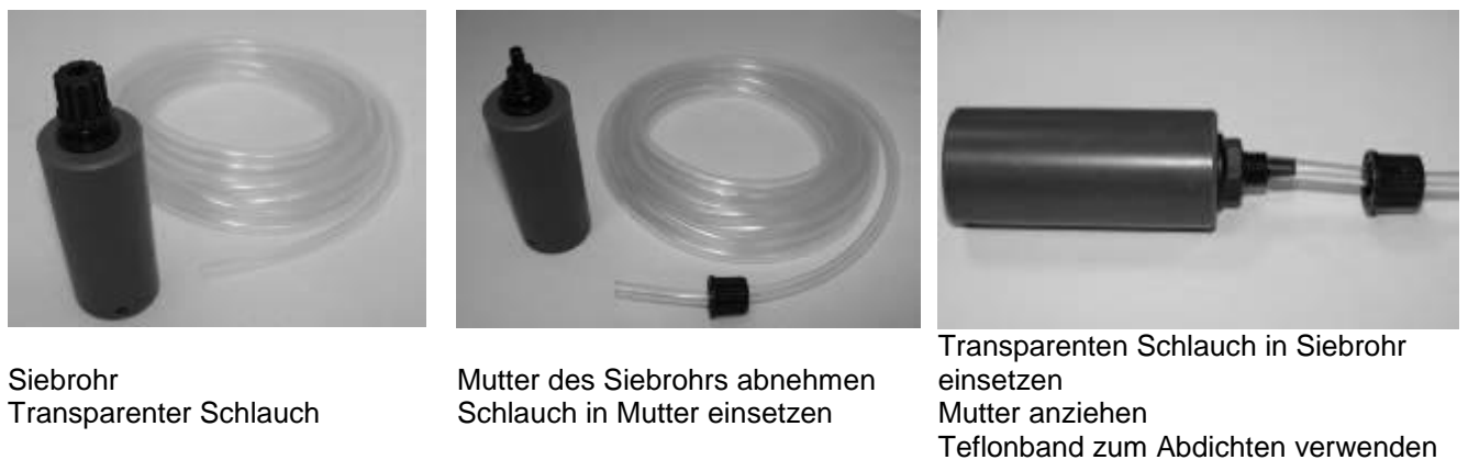
Figure 25. Montage des Siebrohrs
