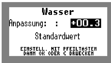
Figure 57. Einstellen des Offset zum Kalibrieren des Wassertempersensors (Abgleich mit Thermometer)
