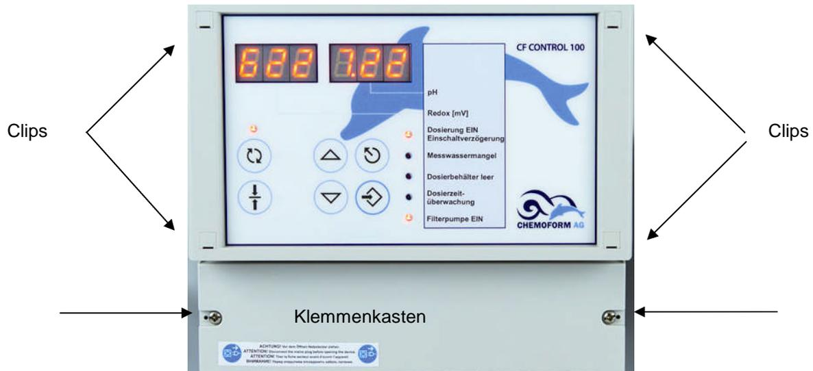
Die beiden Messkabel der Redox- und der pH-Elektrode sind werksseitig angeschlossen. Diese Anschlüsse befinden sich oben rechts im Gerät. Sollten Sie an diesen Anschlüssen arbeiten müssen, entfernen Sie bitte die 4 Clips mit einem Schraubendreher der passenden Breite, um an die Gehäuseschrauben zu gelangen. Nehmen Sie dann den Gehäusedeckel vorsichtig ab.
