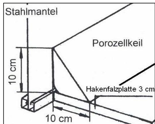
Beim Bodenisolations-SET der Firma Pool Partner sind die Hakenfalzplatten sowie Styropor-Sprühkleber und Styroporkeile enthalten. Mit diesem SET ist es ein leichtes die Hohlkehle zu erstellen.
